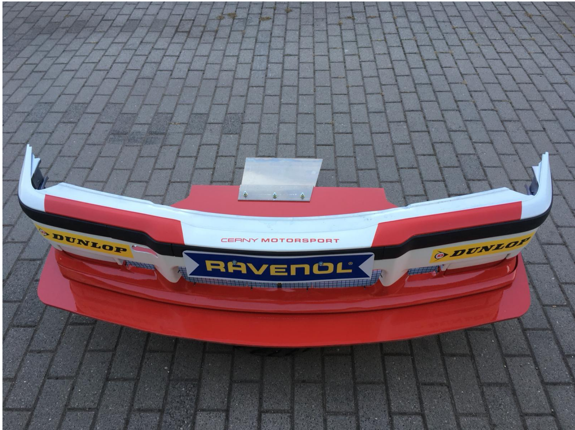
Abbildung 14 (Frontstoßstange mit Splitter)
